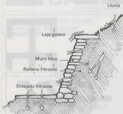
Funcionamiento de los muros como filtros
